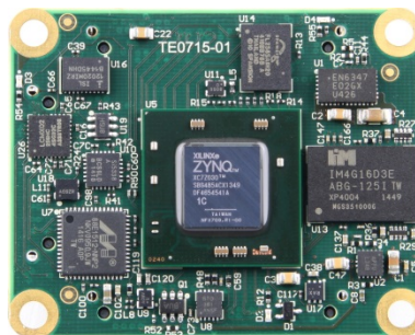
Figure 2 Top of Trenz 4x5 SoM Module - 1:1 Format
